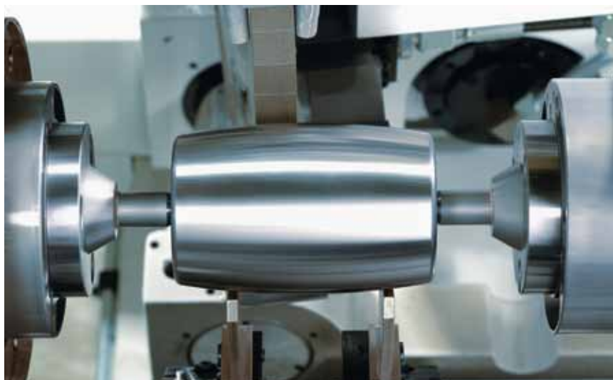
Шлифование в центрах асимметричного профиля бочкообразного ролика.
