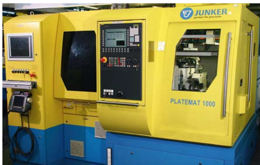
Konsequente Weiterentwicklung: Die Zwei-Scheiben-Technologie verspricht hohe Abtragsraten und feinste Oberflächen, nicht nur für ISO-Wendeschneidplatten.
