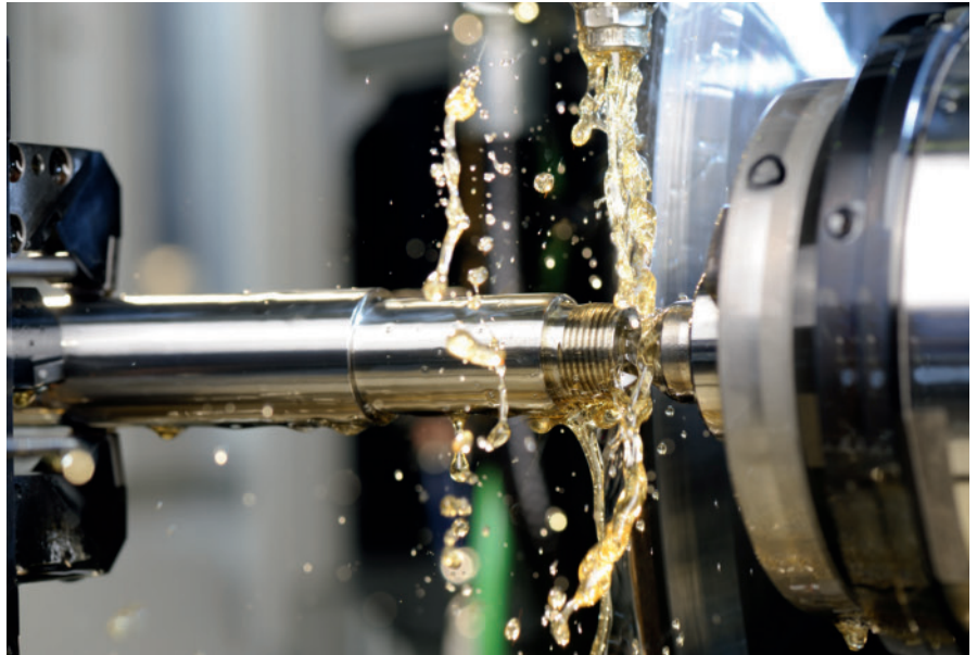
2 Geschliffenes Gewinde: Eine der drei Stationen des Schleifspindelstockes der Quickpoint 5000 für den chinesischen Kunden trägt die CBN-Schleifscheibe für das Gewindeschleifen. Der Kunde kann jedoch jederzeit andere Scheiben montieren
