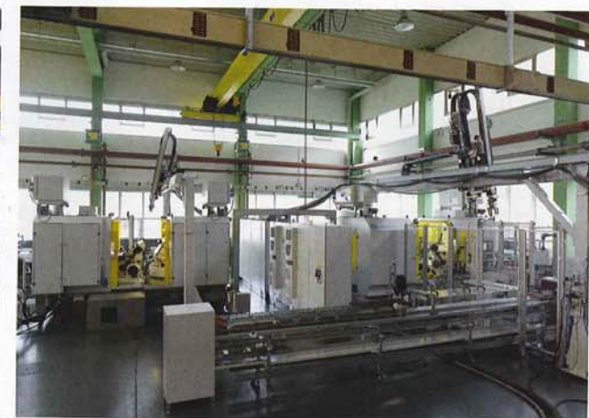
Teilansicht der PKW Nockenwellenlinie für die vollautomatisierte Massenfertigung von 4 Zyl. PKW Nockenwellen.
