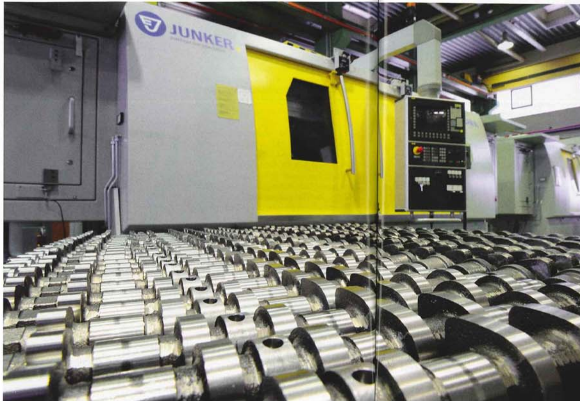
Spitzenlos-Rundschleifmaschine Jupiter 500 mit Messzelle zur Typerkennung der zugeführten Nockenwelle.
