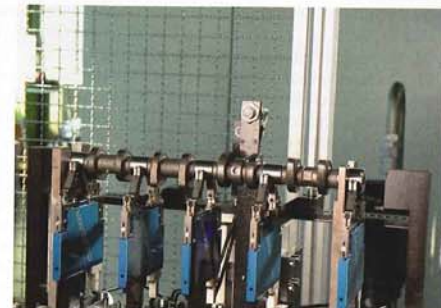
Teilansicht der PKW Nockenwellenlinie für die vollautomatisierte Massenfertigung von 4 Zyl. PKW Nockenwellen.
