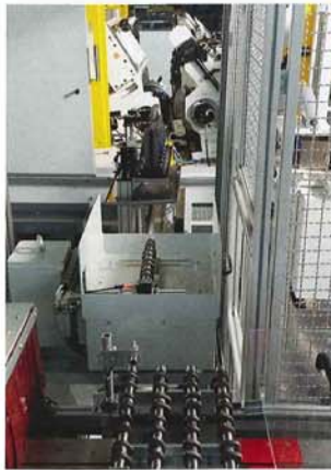
Spitzenlos-Rundschleifmaschine Jupiter 500 mit Messzelle zur Typerkennung der zugeführten Nockenwelle.
