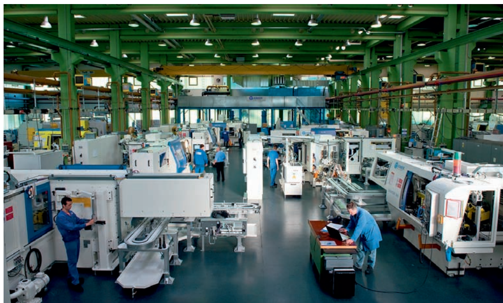
4 Junker-Projektierungshalle in Nordrach: Ein Teil der testfertigen Schleifmaschinen für das Getriebewellenprojekt bei FPT im Aufbau, inklusive der Teilelogistik-Bänder
