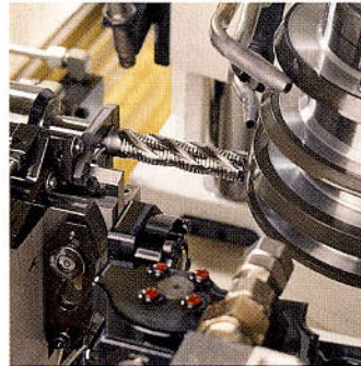
Jumaximat: Bearbeitung von Spiralnuten, Schruppverzahnung und Stirngeometrie in einer Einspannung
