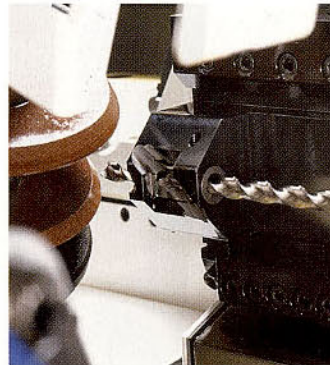
Drillmat 3000: Bearbeitung von Nuten, Rücken und Schneidengeometrie von Spiralbohrern in einer Einspannung
