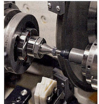
Platemat 1000, die neue Hochleistungs-Schleifmaschine für die Bearbeitung von Wendeschneidplatten in einer Einspannung
