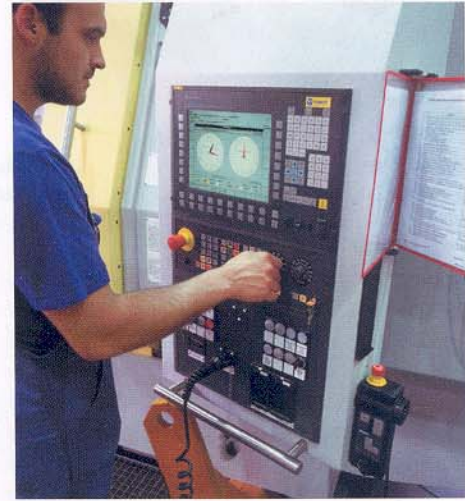
Bild 2: Standardisiertes Konzept für einheitliches B&B: EJOP mit Operator Panel OP012, Maschinensteuertafel und kundenspezifisch ausführbarer Drückerplatte
