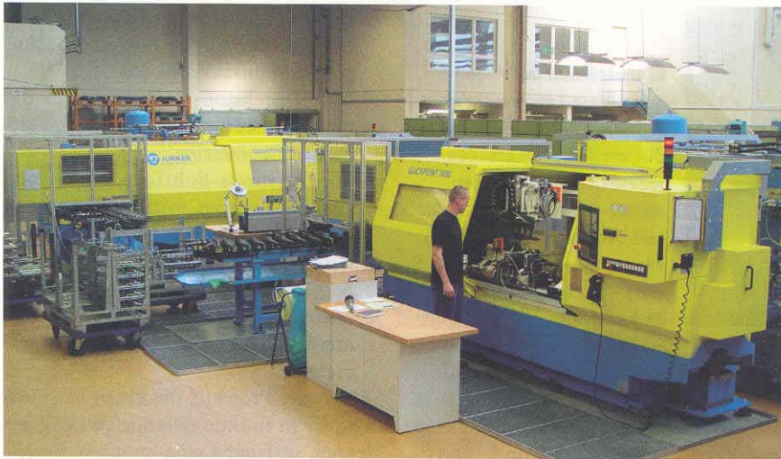
4 Dreischichtig unter Volldampf: Die zwei Quickpoint-Maschinen mit außen liegendem Ladesystem und innen liegendem Portal werden von einem Mitarbeiter betreut, was nochmals einen sechsstelligen Eurobetrag im Jahr einspart
