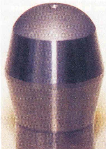
Bild 3: Das Schleifen der Außenkontur des Ziehstempels nach dem Quickpoint-Verfahren dauerte nur 2,5 min, konventionell geschliffen waren es 25 min.
