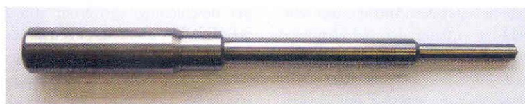
Bild 2: Im Vergleich zum konventionellen Schleifverfahren reduzierte das Quickpoint-Verfahren die Schleifzeit für die Außendurchmesser eines Stufenbohrers von 35 auf 7 min.
