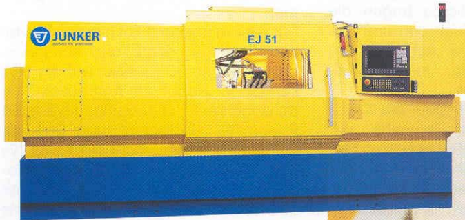
Schwergewicht: Für große Werkstücke, wie Kurbelwellen für mehrzylindrige Verbrennungsmotoren oder Kompressoren, ausgelegte CNC-Schleifmaschine „EJ“ 51
