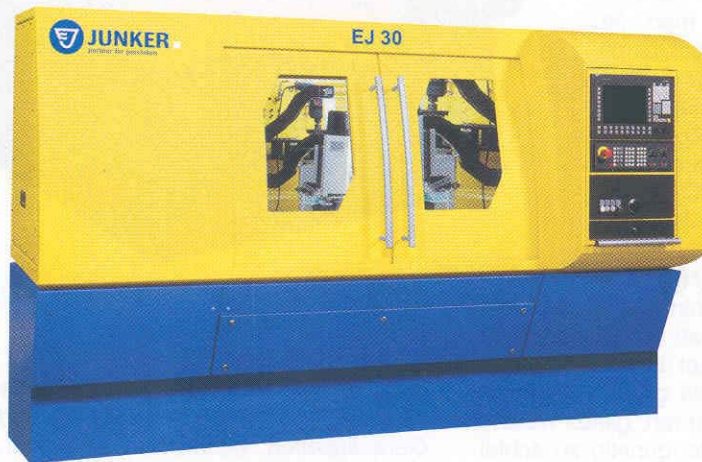
Universell für kleine bis mittelgroße Werkstücke: Die modular auf einer standardisierten Plattform aufgebauten CNC-Schleifmaschinen „EJ“ 30
