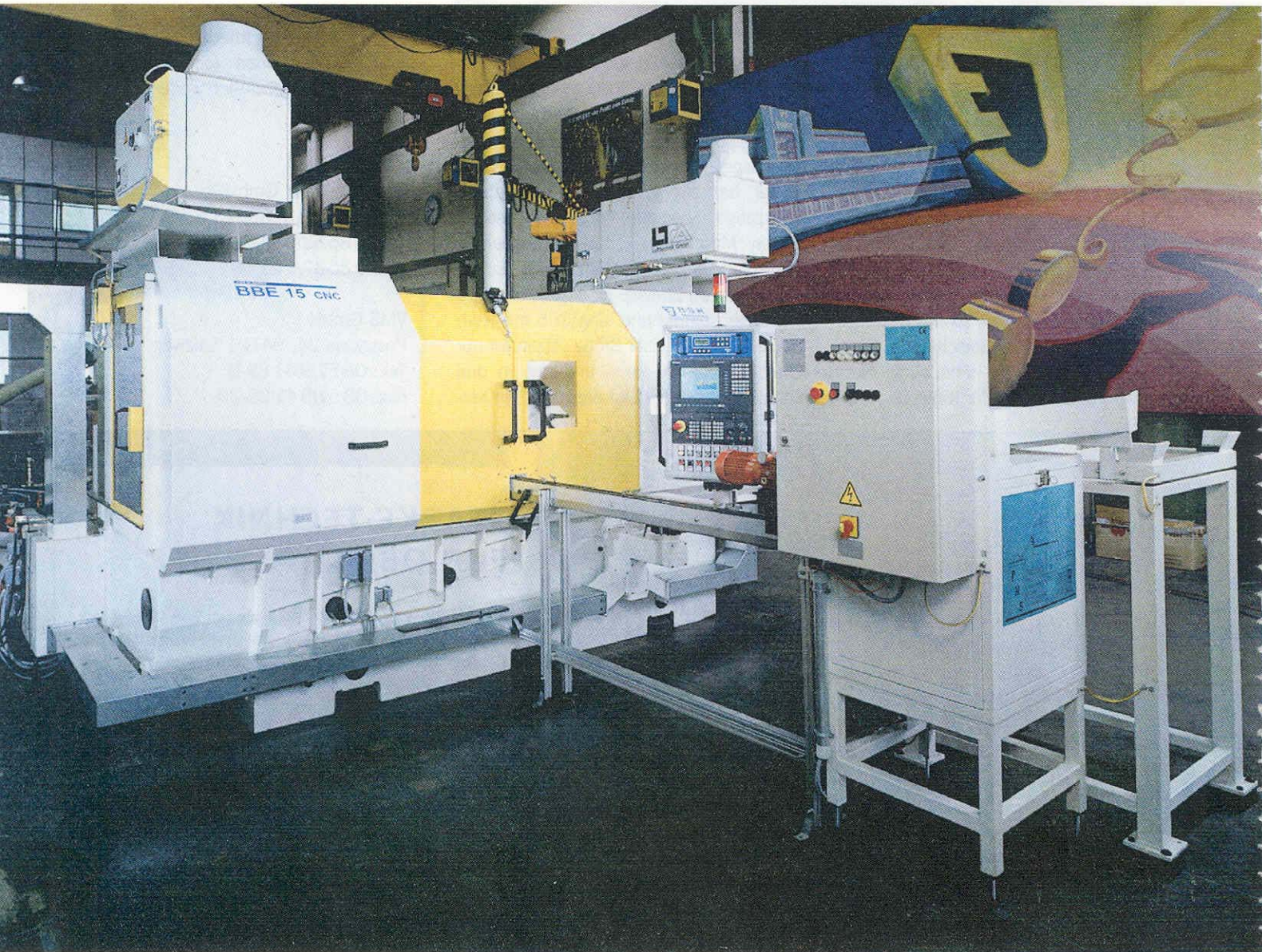
Die Hochleistungs-Spitzenlos Außenrundscheifmaschine „Jupiter 500“ mit Neun-Achsen-CNC und Hebe- kran für den schnellen und bequemen Schleifscheibenwechsel.
