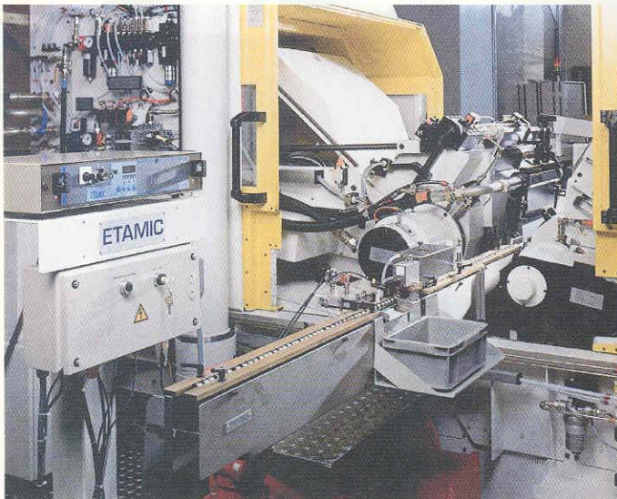
Frontansicht mit geöffneter Maschinenhaube: gut zugänglicher Schleifraum mit integrierter Qualitätskontrolle der geschliffenen Werkstücke.
